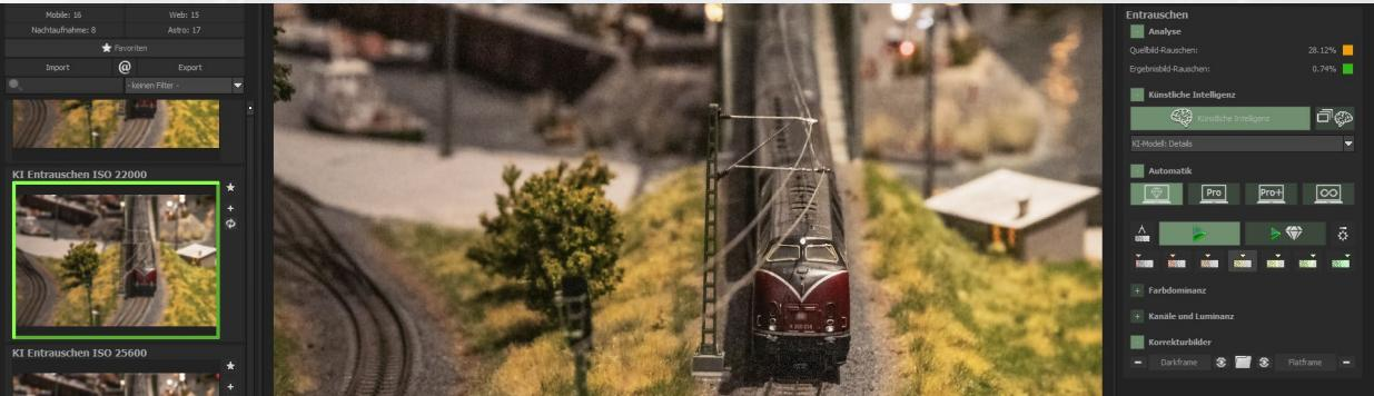
Die automatisch analysierten Werte des Bildrauschens werden mit den zwei ermittelten Werten des **Quellbild-Rauschens** und **Ergebnisbild-Rauschens** eingeblendet und durch 2 „Ampelfarben“ visualisiert.
